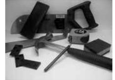
Pour scier les planches, utilisez une scie à main à dents fines, une scie sauteuse, une scie à découper, une guillotine ou un couteau universel.
