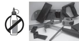
Pour scier les planches, utilisez une scie à main à dents fines, une scie sauteuse, une scie à découper, une guillotine ou un couteau universel. \*Note : compris dans la trousse d'installation TORLYS \*\* FACULTATIF : pour faciliter l'installation et les réparations, utilisez l'outil BulldogMC TORLYS.
