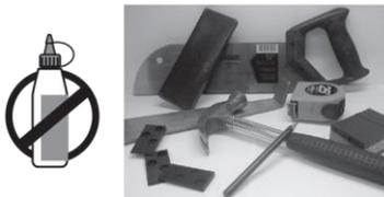
Pour scier les planches, utilisez une scie à main à dents fines, une scie sauteuse, une scie à découper, ou une guillotine.
